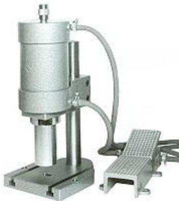
可自动操作执行捶击式探头的测试功能。探头针尖可刺穿任何硬木。通过足部真空管操作，无需用手，操作简单，测试快捷。探头可和所有 AQUA-BOY 主机相连，指定操作压力为 6 bars。更高压力则通过内置释放栓释放，无害。
