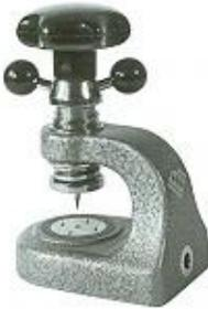
可精确测试厚度达 30mm 的材料，探针不可调节，可以进行含水量斜率测试。探头由通用连接线与主机相连。
