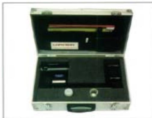
C-103 液压拔出仪包括：量程为 0~60kN 的传感器，最小刻度为 0.5kN，注油杯的油瓶，小工具，操作手册及标定证书
