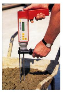
将探头插入混凝土中,按下触发开关。 探头旋转8秒后停止,转换测点,重复 做十次
