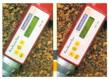
对已知成份的混凝土,只要它曾经被标定过,FCT 101就可以 估测出混合料的水灰比及28天抗压强度预测值
