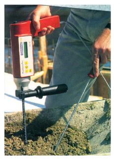
用附加的温度探头测试混合料的温度
