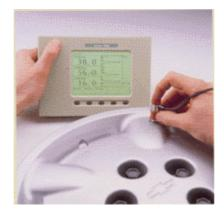
本测厚仪应用超声波技术,可容易、准确地测量单层或多层涂层之厚度。适用基材包括混凝土、木材、塑料、玻璃、陶瓷、金属以及其它很多材料。
