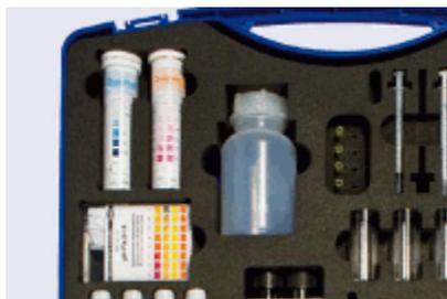
QUANTOFIX® 测试条, pH-Fix 测试条, pH 试纸
