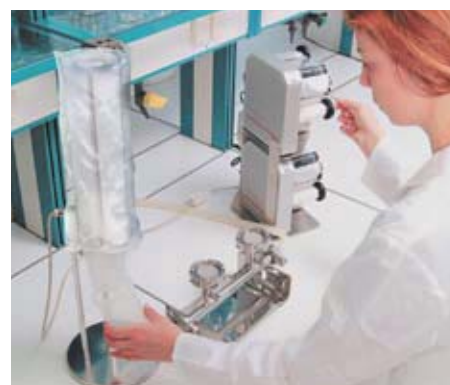
图1 取一支新的预灭菌漏斗，自动分配一个滤膜。（下页继续介绍工作流程）
