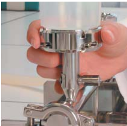
图2 预灭菌漏斗被安装在滤膜上过滤器底座上。
