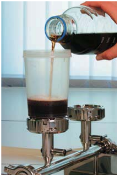
图3 将液体倒入漏斗并激活真空。
