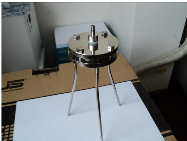
(7) 陶瓷膜组件: MF-01 ; 0.1-0.2 微米 ; 压力 0~0.3MPa
