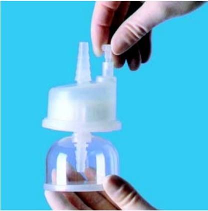
这两种过滤器配有 0.45 μm + 0.2 μm 的双层醋酸纤维素膜，不含表面活性剂，对蛋白的吸附极低。
