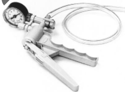
该真空泵可以提供80%的真空度(600 mmHg), PVC 材质, 配有压力表、放气阀和 60 cm 长的透明真空软管, 小巧轻便, 在实验室外应用尤为方便。
