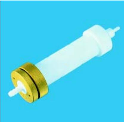
所有与料液接触的部位均由 PTFE 制成，无痕量元素溶出，可以耐受几乎所有的有机溶剂和腐蚀性液体。滤器上盖用 Viton O 形圈密封，用手即可拧紧，如果需要，也可以换成 PTFE O 形圈（产品编号：17039）。
