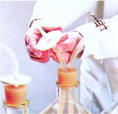
Midisart®-2000 的独特设计使它具有通量大和安全性高的特点。滤膜采用了聚丙烯网增强技术，耐压高达 3bar，20 cm<sup>2</sup> 的过滤面积，使其在较低的压差下就能达到高通量。仅 20g 的重量不会压弯软管而阻碍换气功能。梯形软管接口可以方便地与内径 6-12 mm 的软管连接。
