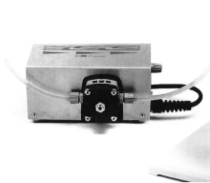
这是一种带有电子调速器的自吸式 PTFE 隔膜泵，标准配置中含有 2.5 米长的硅胶管（内径 4 mm，壁厚 1.5 mm）、不锈钢珠和 5 个接头，因此与 Sartolab-P20 型过滤器相连时，不需要任何其它的配件。用这种隔膜泵送液，不仅静音，而且剪切力非常低。该泵操作压力预设为 2.5 bar，这是连接 Sartolab-P20 型过滤器的推荐压力。
