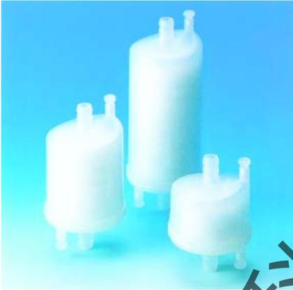
聚丙烯过滤器外壳内装有双层折叠膜。第一层膜孔径较第二层大，作为预过滤层。这种组合提高了流速，并保证了高通量。
