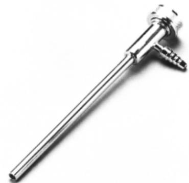
这是一种不用电的简易真空泵, 带有 3/4" 阳螺纹接口, 接在水龙头上, 打开水龙头, 通过喷射出的水流即可产生负压。尤其适合在易燃、易爆场所, 放射性、腐蚀性强的环境现场使用。具有结构简单, 轻便, 运行可靠, 无渗漏, 不需维修等特点。
