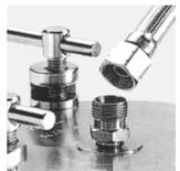
耐压软管的两端也可以加装快接头（6985128），这种快接头的备用配件包括一套 O 形圈和垫圈（6985216）。快接头的优点是连接和断开都非常方便，且在断开时，接头端自动关闭。清洗时，可用 trigger valve（6980407）将接头打开。
