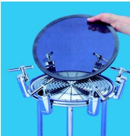
不锈钢的固定夹使拆装顶盘的操作更为方便，因为即使在开启状态，夹子仍连在底盘上。而排液口筛网和滤膜支撑筛网的设计，最大限度地减少了阻力，增加了滤膜的利用率，使整个过滤系统的流量随着滤膜孔径的增大而稳定地增长。
