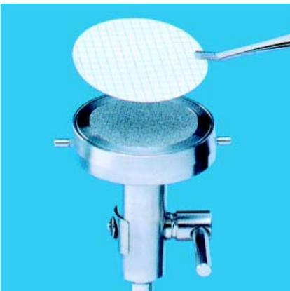
不锈钢滤器有三种型号，分别配有 500 ml、100 ml 和 40 ml 漏斗，可根据过滤量灵活选择。其中 500 ml 和 100 ml 为带盖漏斗，漏斗盖中央留有通气孔，在抽滤时可以塞入棉塞或加装空气滤器以避免二次污染。
