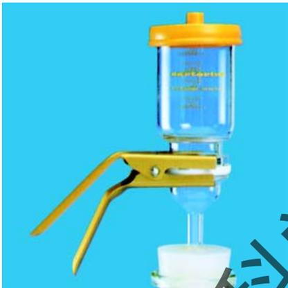
固定滤膜支撑垫的 PTFE 保护垫圈，不仅能保护易碎的玻璃支撑垫，而且在对整个过滤系统进行高压灭菌时，还能起到防止滤膜粘在支撑垫上的作用。该垫圈上端带有边框，便于固定漏斗，下端配合 O 形圈，防止渗漏。
