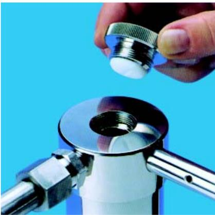
在过滤少量较难滤过的样品时（如胶体、血清和油等），可将滤器直接与压力源连接。如果过滤量较大，样品又相对容易滤过时（如缓冲液的除颗粒或细胞培养液的除菌过滤等），则在滤器和压力源之间连接一个盛装样品的压力罐。
