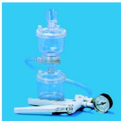
漏斗上盖留有开口，使您无需旋开上盖就可加样。为了防止滤过液二次污染和保护真空泵，请在滤器和真空泵之间加装一个 13 mm 过滤器(订购滤器时附带的标准配件，滤膜需单独订购，产品编号 13400-013S)，或加装一个 Minisart® SRP 针头滤器(需单独订购，产品编号 17576K-50/pk)。
