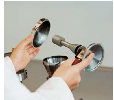
6. 灼烧漏斗内侧和漏斗盖
