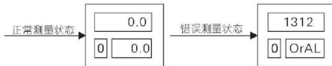
按接线图正确接线后，并检查无误后才能上电。仪表自检后，进入测量值显示状态。如显示OrAL则表示输入超过量程输入信号开路In参数有误。
