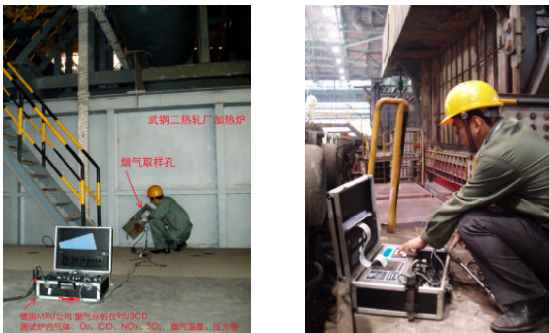
图 3 烟气分析仪 MRU 95/3CD 在轧钢加热炉燃烧调节和控制中的应用
